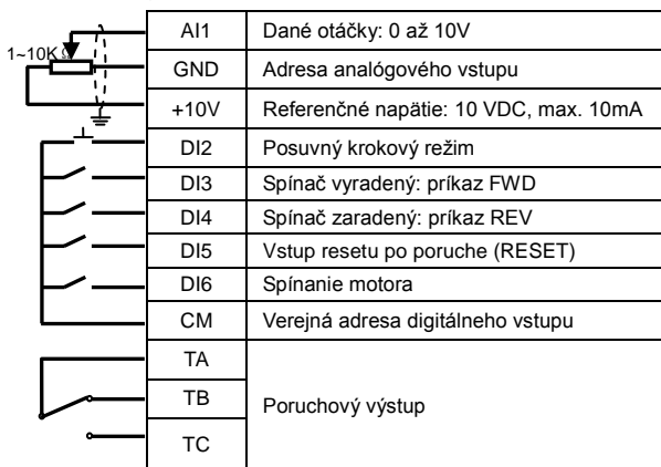
Obrázok 7-4 Diagram zapojenia nastavenia AI1 pre makro pohonu vretena nástroja zariadenia
